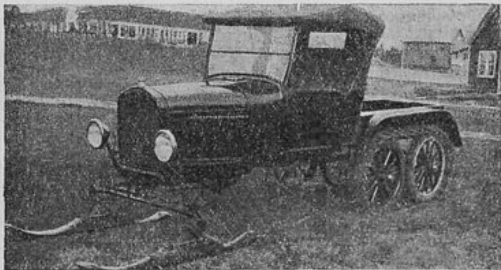
Приспособление для зимней езды „Сноу-Берд“ (снежная птица), установленное на „Форде Т“
